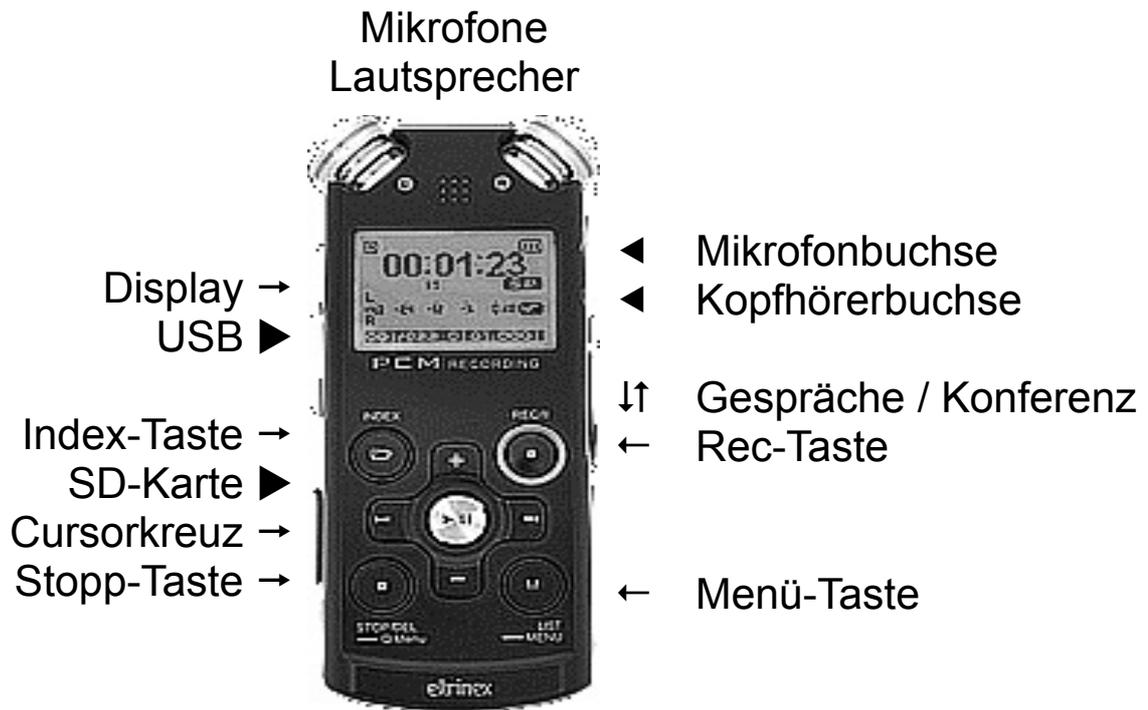
Die Bedienelemente befinden sich auf der Vorderseite sowie auf der rechten und linken Seite des Gerätes. Auf der Vorderseite befinden sich insgesamt 9 Tasten. Die Zentraltaste hat eine kleine Vertiefung und wird als PLAY bezeichnet. Rund um sie herum befindet sich ein Richtungskreuz mit Tasten nach oben, nach unten, nach rechts und nach links. Es besteht aus hervorstehenden Tasten.
