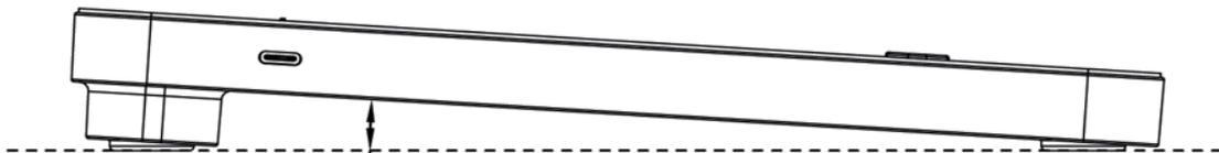
Auf der linken Seite des Dot Pad 320 befindet sich ein USB Typ-C-Anschluss, der speziell für die Datenübertragung vorgesehen ist und nur für den administrativen Zugriff genutzt werden kann.
