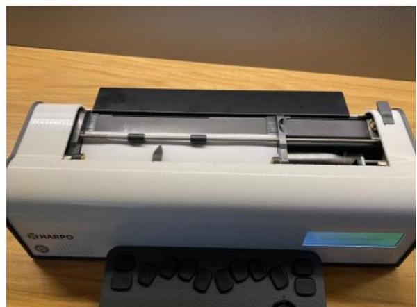
1. Heben Sie den Papierhebel an, der sich auf der rechten Seite Ihres Brailleurs im hinteren Teil befindet, und schieben Sie den rechten Rand an die Position, die dem verwendeten Papierformat entspricht. Legen Sie das Papier flach auf den Lesetisch. Stellen Sie sicher, dass das Papier so positioniert ist, dass es unter die kleinen Walzen am linken und rechten Rand und unter den Prägekopf passt.
