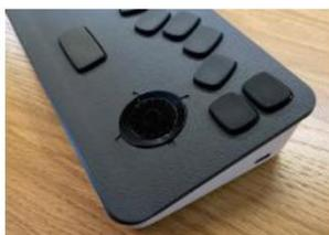
Auf der Tastatur befinden sich 8 Braille-Punktasten. Je nach verwendeter Sprache kann Braille 6-Punkt oder 8-Punkt. Die 8-Punkt-Tastatur ist für beides geeignet. Um Braille einzugeben, müssen mehrere Tasten gleichzeitig gedrückt werden. Jede Punktaste erzeugt beim Prägen einen Punkt auf dem Papier.
