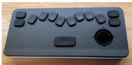
Auf der rechten Seite der Tastatur befindet sich eine zusätzliche USB-C-Buchse zum Aufladen. Dieses kabelgebundene Laden ist schneller als das normale kabellose Laden. Sie müssen die Tastatur vor dem MB Tutor-Hauptgerät platzieren, um sie drahtlos aufzuladen. Wenn sich die Tastatur in der Nähe der Mitte des Gehäuses der Haupteinheit befindet, führen Magnete im Inneren sie in die richtige Ladeposition.
