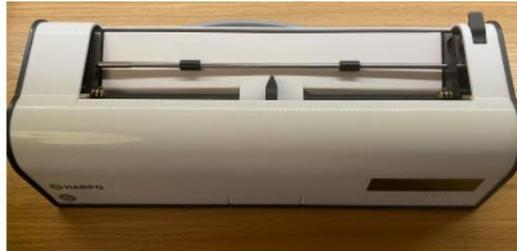
der MB Tutor ist unterwegs. Der Einsatz wird durch den Papierbügel gehalten. Heben Sie zum Entfernen zuerst den Papierhebel an. Denken Sie daran, dies zu tun, **bevor Sie das Gerät zum ersten Mal einschalten**. Der Prägekopf darf bei eingeschalteter Maschine nicht blockiert werden.
