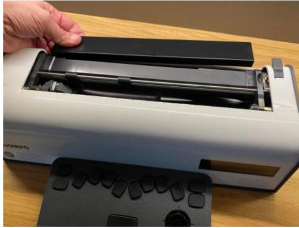
Abb. 3 Installation des Lesetisches
