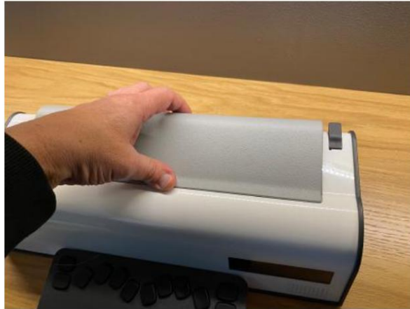
Abb. 1 Entfernen der oberen Abdeckung des Mountbatten Brailier Tutor
