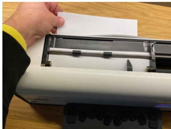
Abb. 6: Einlegen von Papier von der Rückseite des MB Tutor
