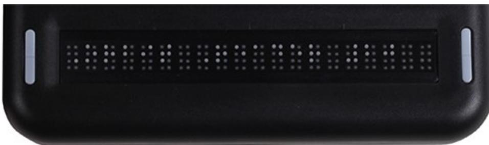
Wenn Sie sich nach oben und von Ihnen weg bewegen, finden Sie eine Reihe von drei Tasten mit einer breiteren Taste in der Mitte. Die breite Taste ist die Leertaste. Die Eingabe-Taste für Punkt 7 befindet sich links von der Leertaste und die Eingabe-Taste für Punkt 8 befindet sich rechts von der Leertaste.
