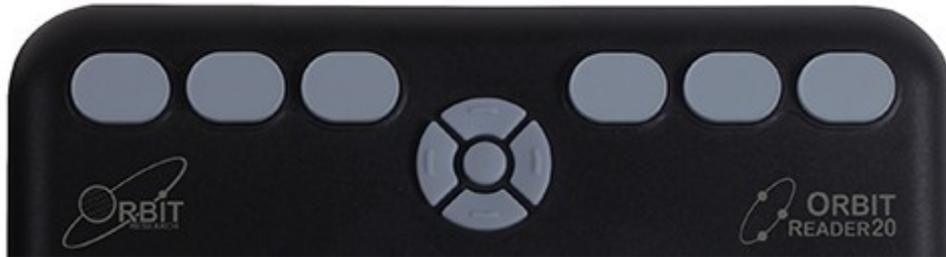
Im Stand-Alone-Modus werden die Braille-Eingabetasten zur Navigation und zum Bearbeiten / Schreiben verwendet.
