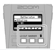
Stellen Sie den benutzten Batterietyp korrekt ein, damit die verbleibende Batteriekapazität exakt dargestellt werden kann.
